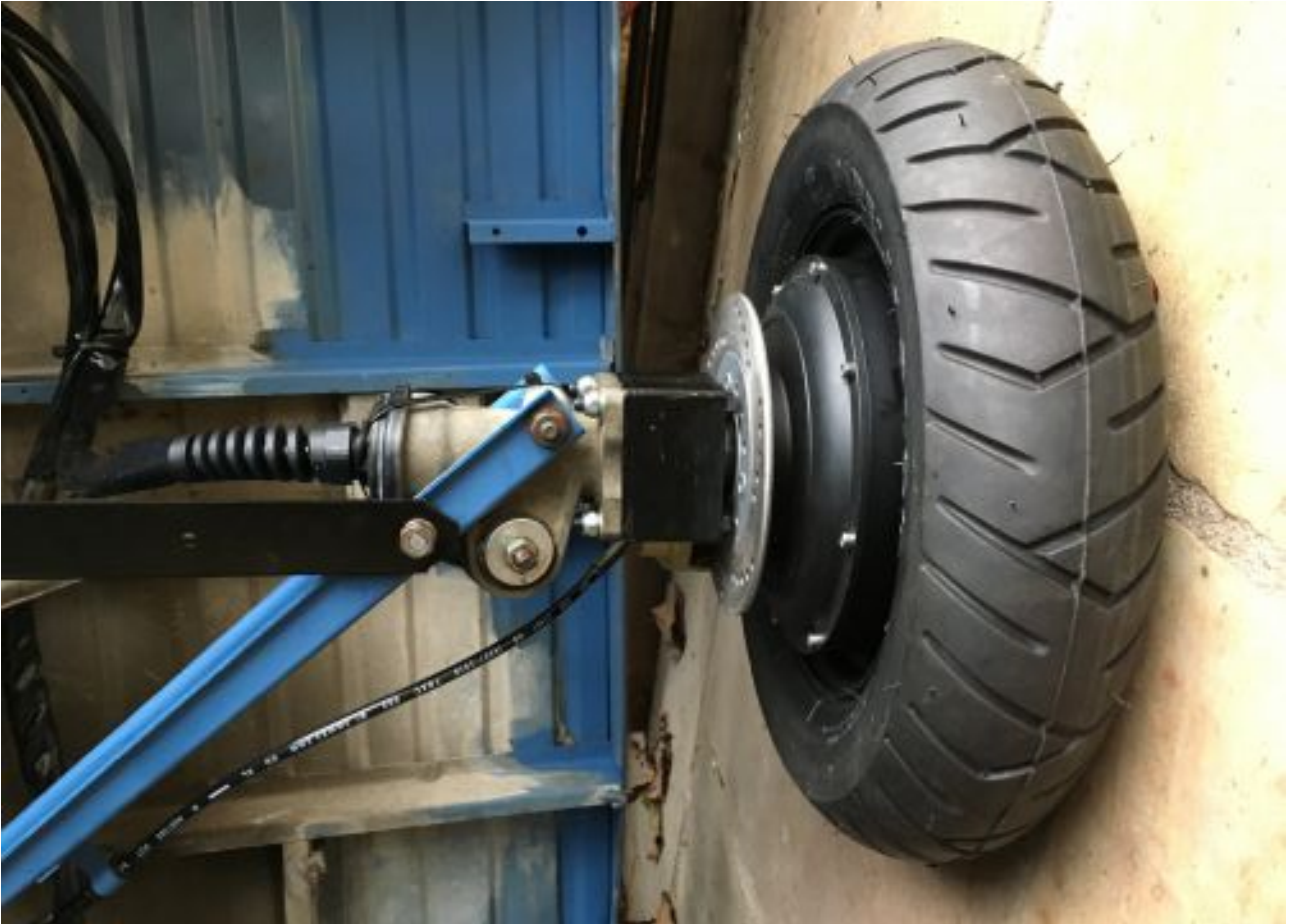
Motorhalter, Radnabenmotor und Radnabengehäuse
